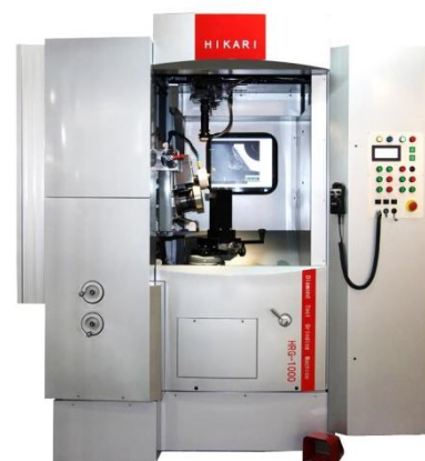
女性の発想が開発に活かされた 「熟練技不要のダイヤモンド工具研削盤」
